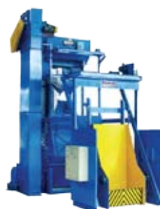
Granalhagem automática (estacionária)
