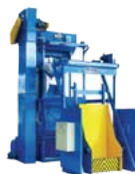
Decapagem por Turbina Fixa
